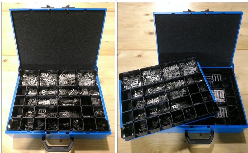
Abb.: Shimkoffer mit zwei Bestückungsebenen (SK-10342-ST-46-H63-H63-02) bestückt mit 2100 Stück Shim-Abstimmplatten, 7 Shimgrößen mit je 50 Stück der Blechdicken (0,1/ 0,2/ 0,5/ 1,0/ 2,0/ 5,0mm). Shimgrößen: 20x16/ 20x20/ 35x15/ 45x15/ 50x20/ 65x20/ 50x50
