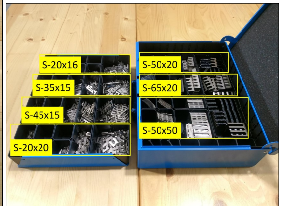
Abb.: Shimkoffer mit zwei Bestückungsebenen (SK-10342-ST-46-H63-H63-02) bestückt mit 2100 Stück Shim-Abstimmplatten, 7 Shimgrößen mit je 50 Stück der Blechdicken (0,1/ 0,2/ 0,5/ 1,0/ 2,0/ 5,0mm). Shimgrößen: 20x16/ 20x20/ 35x15/ 45x15/ 50x20/ 65x20/ 50x50
